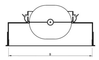
\* Il collarino può essere regolato per un diametro equivalente a piacere fra il minimo e il massimo: ad. es. per 160÷250 il collarino può essere regolato anche per diametri equivalenti 180, 200 e 229 mm. (La serranda a farfalla a corredo non è utilizzabile per 180 e 229).
